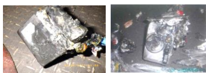
発火原因となったリチウム電池内蔵製品 左(掃除機)、右(デジタルカメラ)
