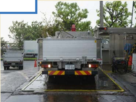
トラックは工場ヤードへの入場時と退場時に重量を測定し、その差で運び込んだ廃棄物の重量分の料金を支払う。
