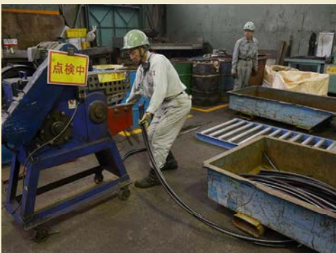
電線などワイヤー類はカットされ、中の銅線が再利用される。
