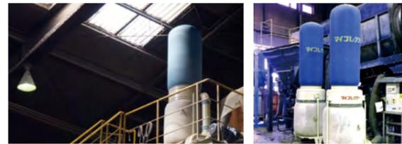
工場内の環境改善のために、本社工場と千葉工場に集塵機を設置しました。プレートファンでフィルターに粉じんを直接押し込む方式の集塵機で、工場内の空気を浄化させることで、社員の健康管理に役立っています。
