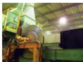
ドラム型ダブル磁力選別機
