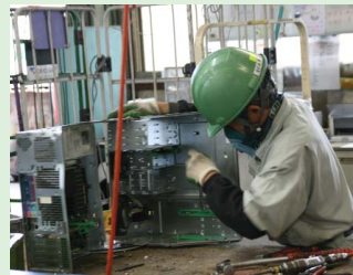
パソコン/OA機器の手解体
